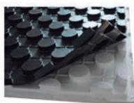
Elemento base de poliestireno moldeado según norma UNE 1264. Con elevado poder aislante, termoacústico y célula cerrada. Tochos integrados en la paca con rebajes laterales para la fijación del tubo. Bordes con doble machihembrado para eliminar la formación de puentes termoacústicos con el forjado. Plastificado con film de gran espesor y alta resistencia, termoconformado independiente y montado sobre aislamiento de poliestireno.
