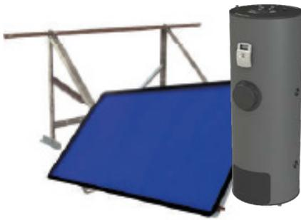
El Sistema solar drainback CSH Premium, está formado por captadores solares de alto rendimiento modelo CSH Premium 22 o 26 y un interacumulador AX 150-500, construido en acero INOX AISI-444 con soldadura a testa indicado para climas tropicales y con un serpentín de intercambio térmico para ACS totalmente extraíble y fabricado en acero INOX AISI-316L.
